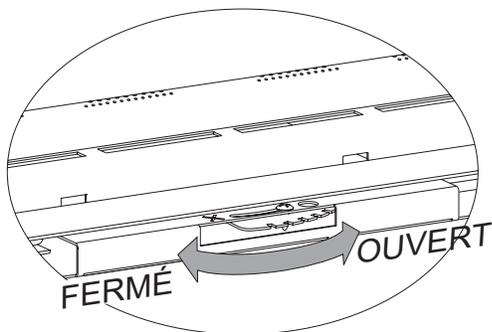
Figure 9 - Obturateur d'air du brûleur arrière
